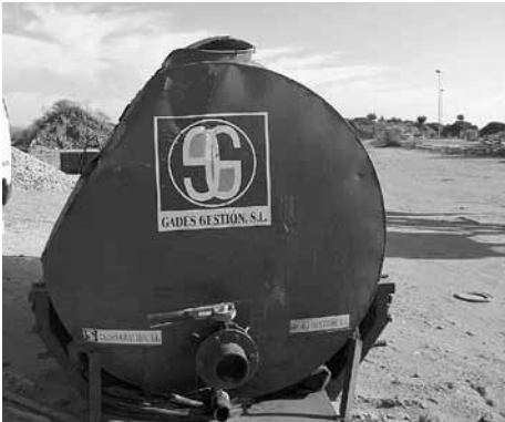
Deformaciones en la cisterna del camión tras el vuelco hacia la izquierda
