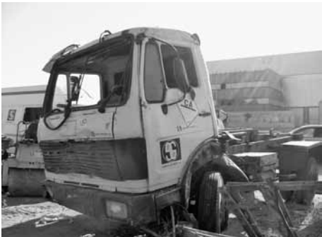
Deformaciones en el frontal del camión por el impacto
