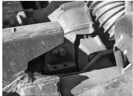
Daños en la estructura inferior del camión por transmisión de fuerza
