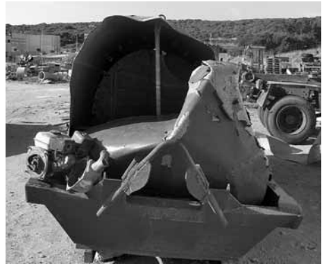
Deformaciones en la cisterna del camión tras el vuelco hacia la izquierda
