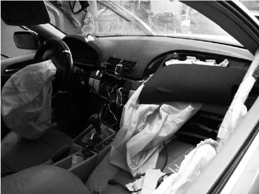
**Foto No. 2 - Airbags delanteros y lateral derecho activados**
