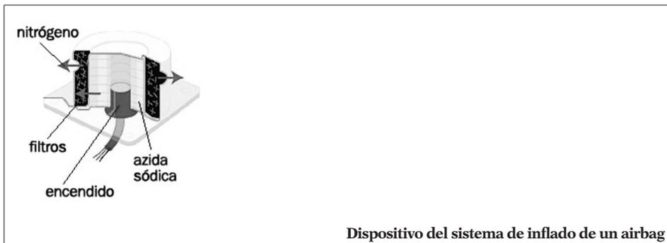
Dispositivo del sistema de inflado de un airbag
